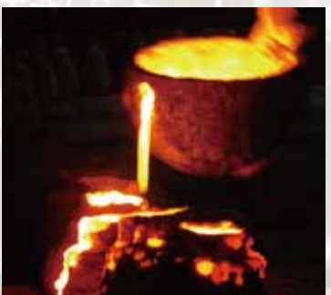
焼成された鋳型に溶解した砂張を注ぐ、緊張の瞬間。鋳型と金属が冷却していく時間経過の中でも、音は変化していきます。
