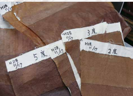
柿渋を塗った色見本。用途によって濃さを選び、乾かしてから重ね塗りを繰り返すことでより堅牢に濃い色になる。
